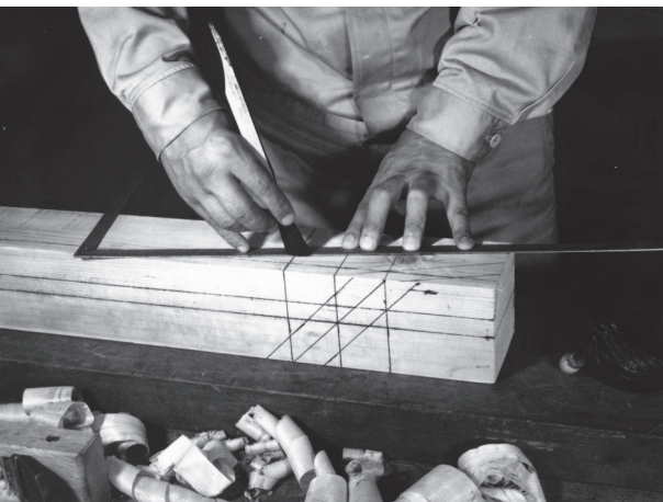
写真1 さしがねを使って墨付け作業…
