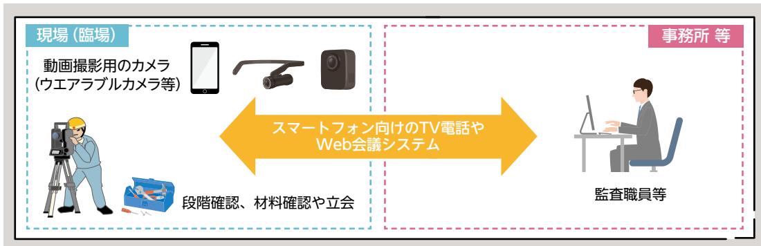
第2図 遠隔臨場の例 (出典：建設現場の遠隔臨場に関する試行要領(案))
